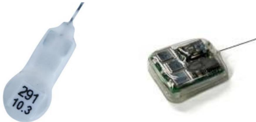
Figure 10 : Type de nano-émetteur : normal et solaire
