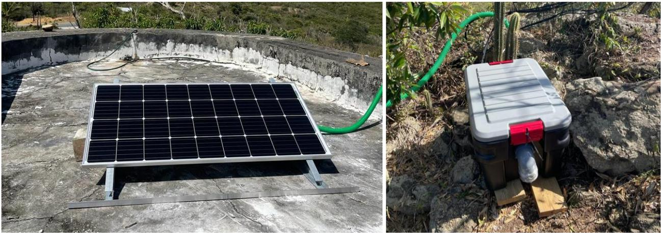
Figure 9 : Panneau solaire et coffre de rangement avec batterie, régulateur et SensorGnome (© Kévin Urvoy)
