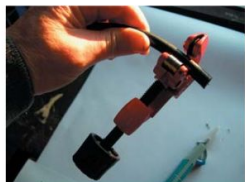
photo 3 : dénuder au moyen d'un petit coupe tuyau
