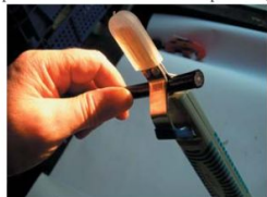
photo 2 : dénuder au moyen d'un couteau à dénuder
